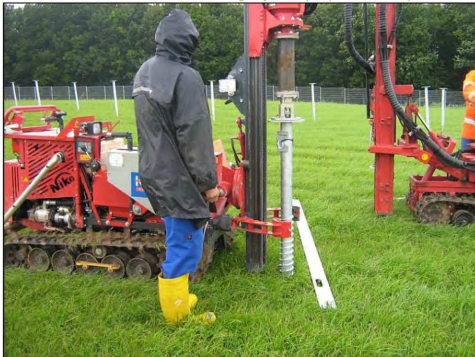
Photo 87 : Machine hydraulique de vissage (source : TSE)
